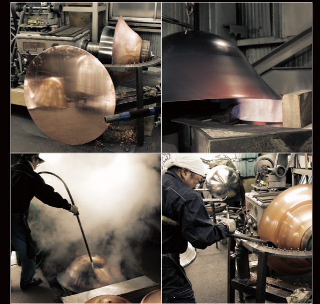
1枚のコパー板、あるいは、アルミ板に、熟練のクラフトマンがヘラを押し当てて、成形していく技術。ヘラのみで均一に仕上げられたケトルは、ヘラ紋りと熱処理を繰り返すことで、強度を増すことで、音程感に優れ、サウンドの輪郭をはっきりと際立たせます。
